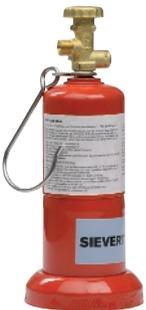
Nachfüllbare Propangas-Flaschen von Sievert werden aus hochwertigem Stahl gefertigt. Die Flaschen sind innen korrosionsgeschützt und von der Außenseite mit einem Schutzlack versehen. Die Flaschen sind mit Bauart zugelassenen Ventilen versehen und verfügen über ein Sicherheitsventil gegen Überdruck.
