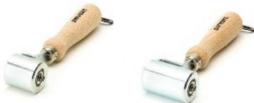
Stahl-Andrückrollen, kugelgelagert für hohen Anpressdruck zur Verschweißung im Überlapp Verfahren von bituminösen Dach- und Dichtungsbahnen. Der ergonomisch geformte Handgriff bietet optimale Handhabung und Dosierung des Anpressdrucks.
